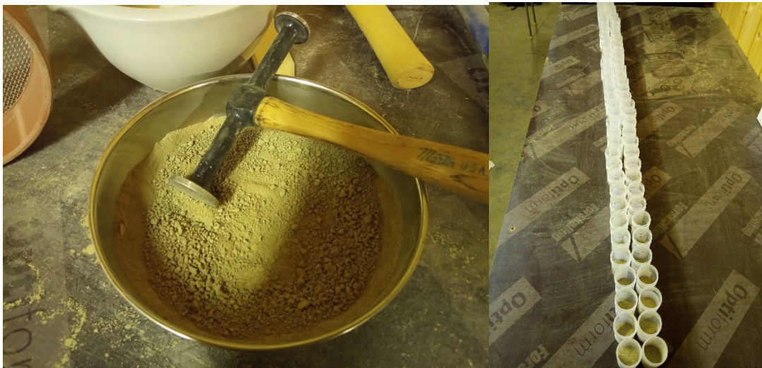
Figur 7 Første runde med oppkvising er utført med oppretterhammer. Prøver klare for å tilsette vann.
