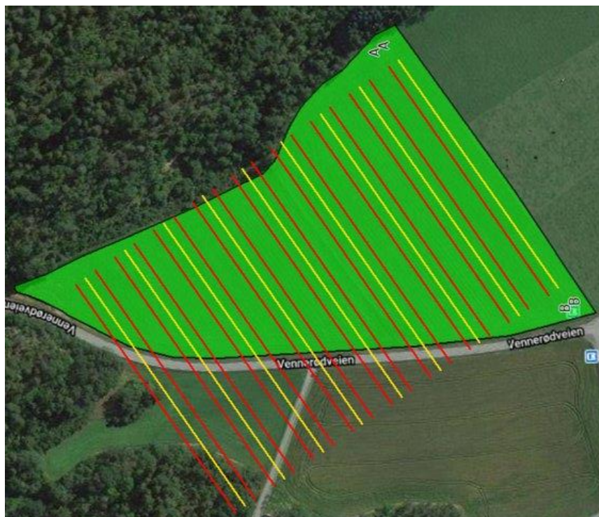
Bilde 13 Planlegging av kjøremønster med parallelspor til grasvogn mellom annethvert kjørespor. Illustrasjon AgLeader sms v/ Per Gunnar Kraggerud/NLR.
